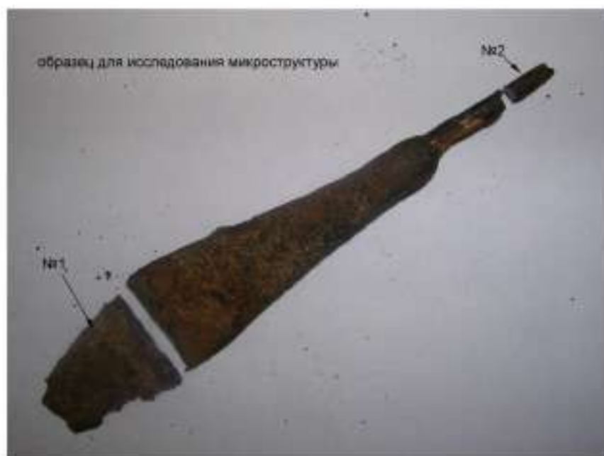
Рис. 26. Зоны для исследования микроструктуры изделия.
